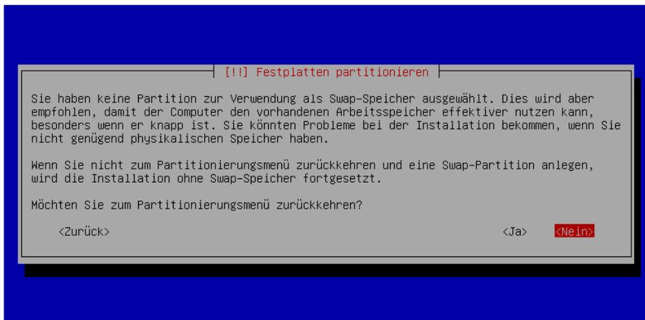
Für die erste Installation auf dem Lab-Server wird auf eine Swap-Partition verzichtet. Diese wird u.a. zum Auslagern des Arbeitsspeichers auf die Festplatte genutzt. Dies ist für die Lab-VMs nicht notwendig.
