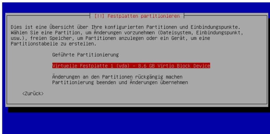
Vor der Installation des Basis-Systems muss die Festplatte partitioniert werden. Dies kann geführt erfolgen, d.h. das Partitionsschema wird vom Installer berechnet und vorgeschlagen, oder manuell.
