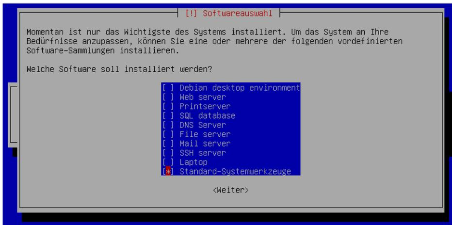
Nach der Installation des Basis-Systems wird ein Spiegel-Server ausgewählt, um weitere Pakete aus dem Internet herunterzuladen und zu installieren. Anschließend können Pakete ausgewählt und installiert werden.
