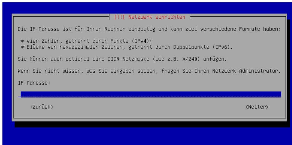
Die Netzwerk-Konfiguration erfolgt entweder über DHCP (wenn vorhanden), wobei IP-Adresse, Netzmaske, Gateway und DNS-Server bezogen werden, oder manuell durch die Eingabe der jeweiligen Angaben.
