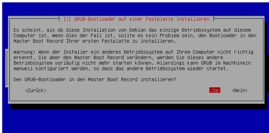
Abschließend wird der Bootloader installiert und die Installation durch ein Reboot fertiggestellt.
