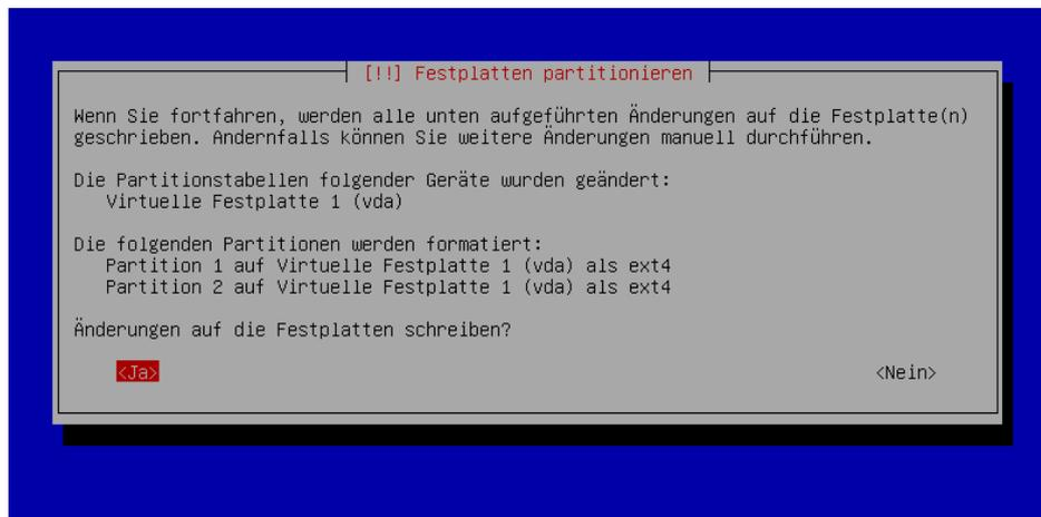
Nachdem das Partitionsschema fertiggestellt wurde, muss dieses bestätigt werden bevor es auf die Festplatte geschrieben wird. Danach folgt die Installation des Basis-Systems.
